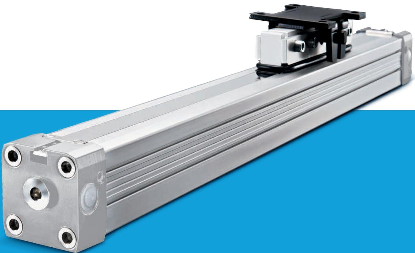
Il corpo del cilindro è scanalato per tutta la sua lunghezza. La forza si trasmette attraverso il carrello di carico, che è fissato all'asse del pistone. La scanalatura dell'asse del pistone collega la sua parte interna con quella esterna.
