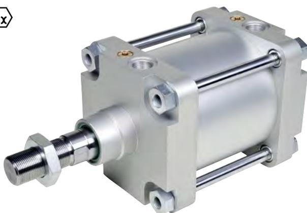
Cilindri costruiti a norma ISO 15552 in versione con tiranti. Realizzato con design pulito. Adatto ad applicazioni particolarmente gravose. Disponibili in versione magnetica o non, con o senza ammortizzo regolabile, a stelo singolo o passante. Ampia gamma di accessori. Su richiesta sono fornibili in varie esecuzioni speciali ed in versione conforme alla direttiva 2014/34/UE ATEX.
