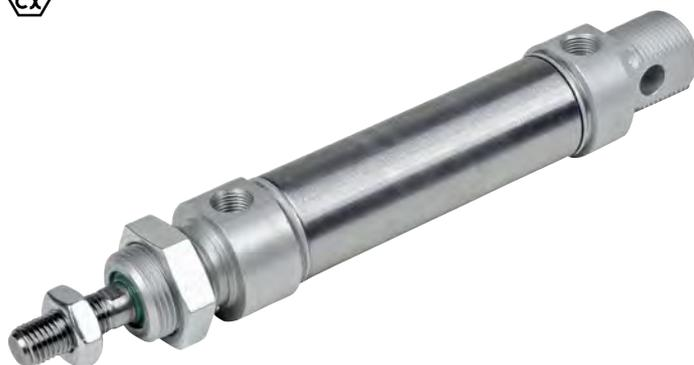
Cilindri costruiti a norma ISO6432. Altamente resistenti con testate cianfrinate. Fornito con dado testata e dado sullo stelo. Esecuzione magnetica e non, ammortizzata e non. Disponibile anche a semplice effetto. Vasta scelta di accessori di fissaggio. A richiesta in conformità alla Direttiva ATEX.
