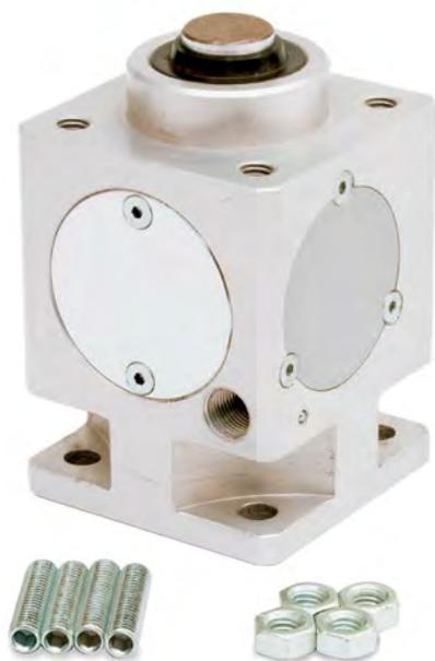
Il bloccastelo è un dispositivo meccanico da applicare ai cilindri ISO 15552 e ISO 6432 VDMA il cui scopo è quello di bloccare lo stelo dei cilindri in qualsiasi posizione. Questa soluzione permette di bloccare la corsa del cilindro in qualsiasi momento si verifichi un'improvvisa caduta di pressione.
