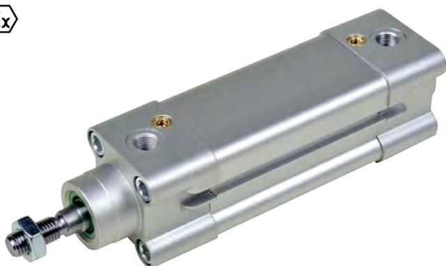
Cilindri costruiti a norma ISO 15552 in versione con tubo profilato. Caratterizzato dal design pulito e da grande resistenza e precisione di montaggio. Disponibili in versione magnetica o non, con o senza ammortizzo regolabile, a stelo singolo o passante. Ampia gamma di accessori. Su richiesta sono fornibili in varie esecuzioni speciali ed in versione conforme alla direttiva 2014/34/UE ATEX.
