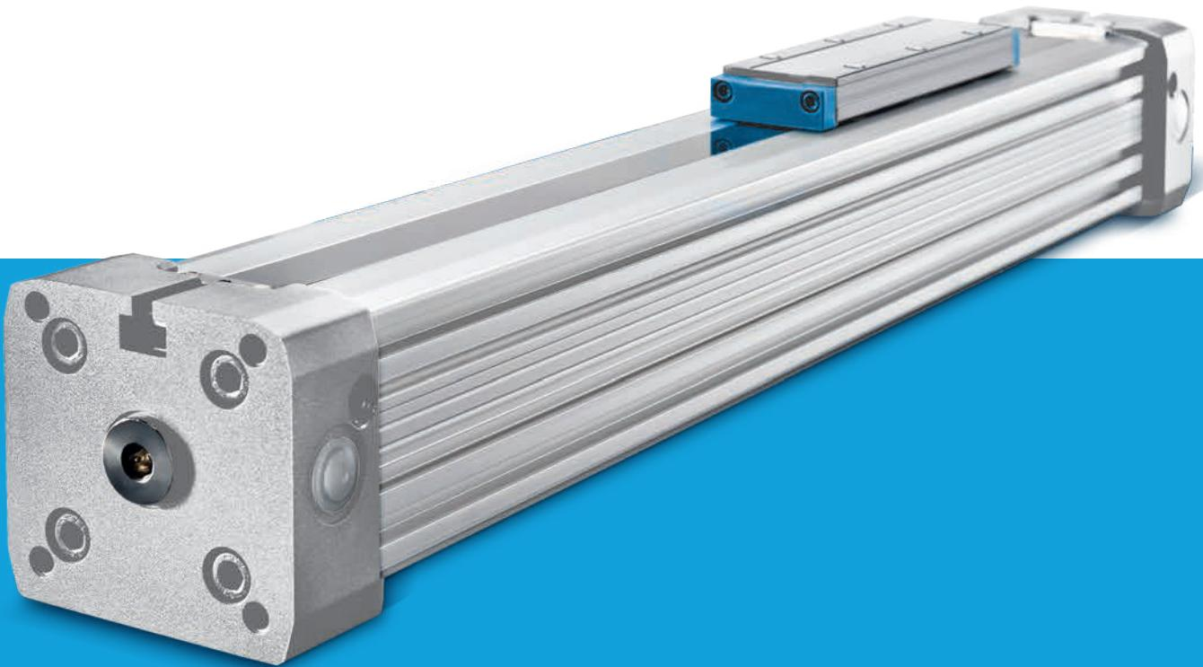
Il corpo del cilindro è scanalato per tutta la sua lunghezza. La forza si trasmette attraverso il carrello di carico, che è fissato all'asse del pistone. La scanalatura dell'asse del pistone collega la sua parte interna con quella esterna.
