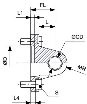
Materiale Corpo in alluminio pressofuso bussole in acciaio e PTFE
