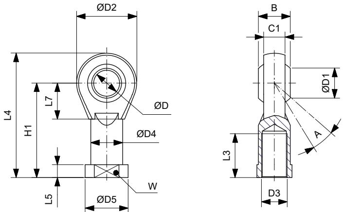
Materiale Corpo acciaio zincato boccola in bronzo sinterizzato
