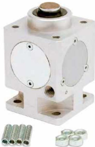
Il bloccastelo è un dispositivo meccanico da applicare ai cilindri ISO 15552 e ISO 6432 VDMA il cui scopo è quello di bloccare lo stelo dei cilindri in qualsiasi posizione. Questa soluzione permette di bloccare la corsa del cilindro in qualsiasi momento si verifichi un'improvvisa caduta di pressione.
