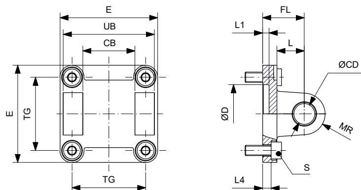
Materiale Corpo in alluminio pressofuso bussole in acciaio e PTFE
