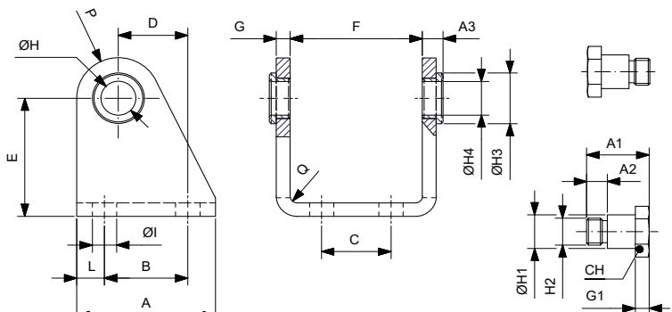
Materiale Perni e corpo in acciaio inox AISI304 bussole in delrin
