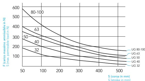
Tipo U con bussole in bronzo - U Type with slide bearings
